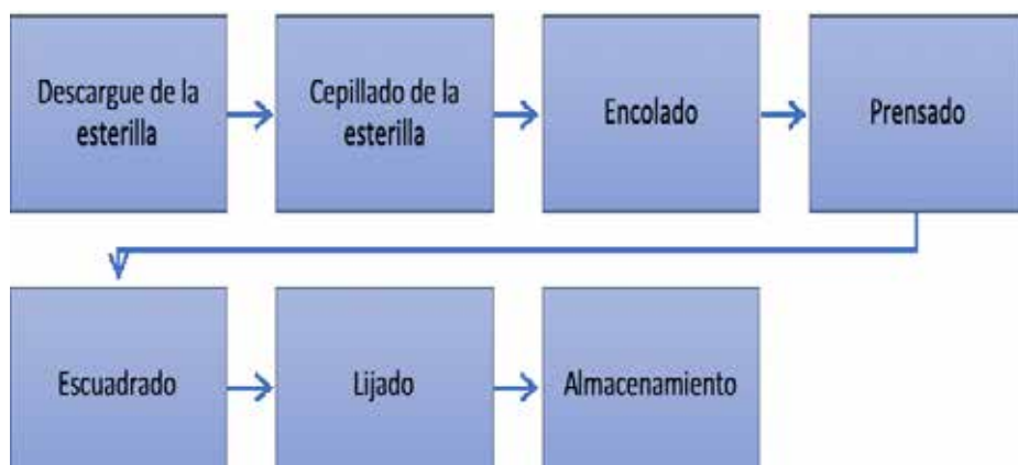
Figura 2 Proceso de fabricación del G.L.G.
